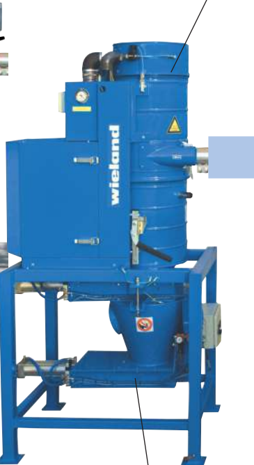
Двойной сдвижной затвор. Постоянная или периодическая выгрузка собранного материала.
