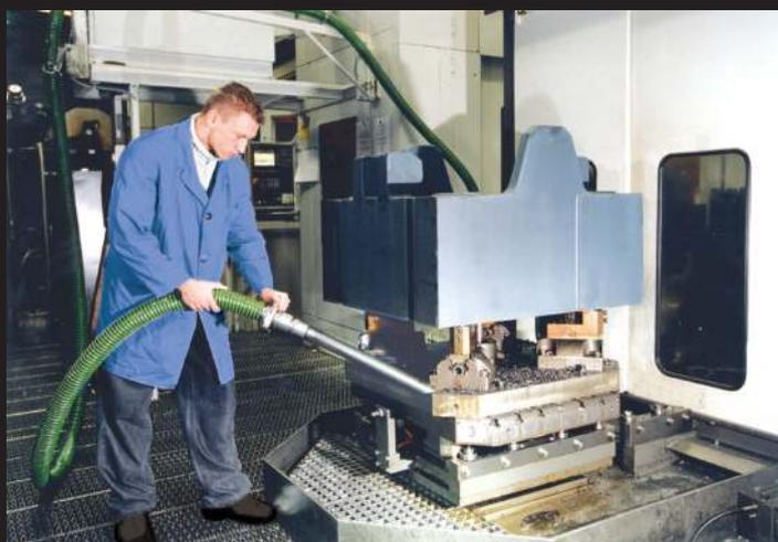
Универсальные передвижные промышленные пылесосы VacPro предназначены для уборки производственных помещений и оборудования от любых видов пыли: абразивной, электропроводящей, волокнистой, влажной, слипающейся, в том числе тонкой опасной для здоровья пыли классов М и Н. С помощью VacPro легко очищать и поддерживать в работоспособном состоянии сложное технологическое оборудование.
