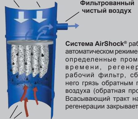
Система AirShock® работает в автоматическом режиме и, через определенные промежутки времени, регенерирует рабочий фильтр, сбивая с него грязь обратным потоком воздуха (обратная продувка). Всасывающий тракт на время регенерации закрывается.
