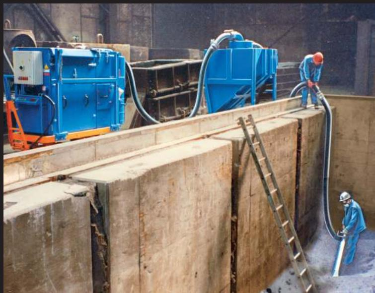
Сборный бункер 120, 160 и 500 л. Стационарное или передвижное исполнение (шасси для тяжелого груза). S-3 способен удовлетворить самые высокие требования к производительности и фильтрующей способности при сборе и вакуумной транспортировке большого количества сыпучего материала.
