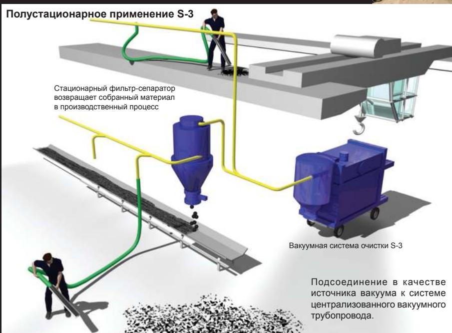
Подсоединение в качестве источника вакуума к системе централизованного вакуумного трубопровода.
