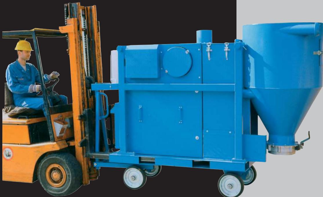
**S-3 - высокопроизводительный вакуумный агрегат,** неоднократно доказавший свою надежность в работе с большими количествами сыпучего материала на предприятиях металлургической промышленности, в сталеплавильных и сталепрокатных цехах, на цементных и гипсовых заводах, тепловых электростанциях, на предприятиях по производству минеральных удобрений.
