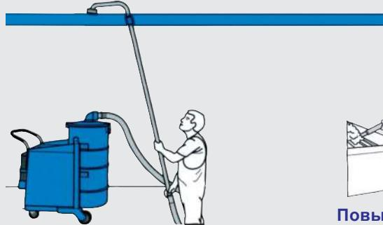
**Оперативная уборка пыли/волокна, сплюснувшегося и комкующегося материала.** Компактный и мобильный пылесос с мощным вихревым вакуумным насосом.
