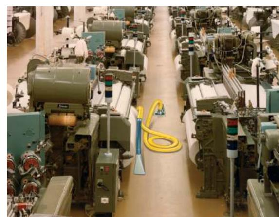
**Вакуумная розетка (клапан)** всегда готова к уборке - при открывании дает команду на включение вакуумного агрегата.
