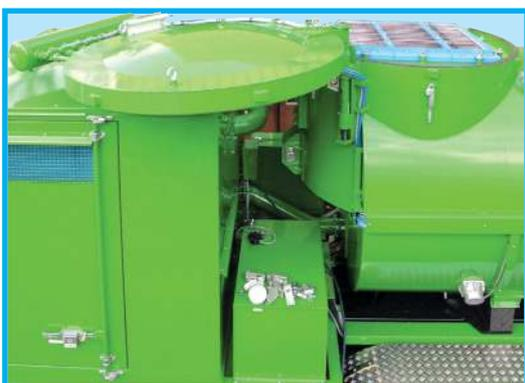
Быстрая и удобная замена основного фильтра. Автоматическая система регенерации основного фильтра **AirShock®** или **Jet**.
