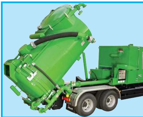
Угол наклона сборного бункера оптимален для выгрузки густых и вязких материалов. При выгрузке бункера автоматически удаляется пыль, оседаемая в камере основного фильтра.
