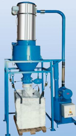
**Система вакуумной транспортировки для заполнения мешков BigBag.**
