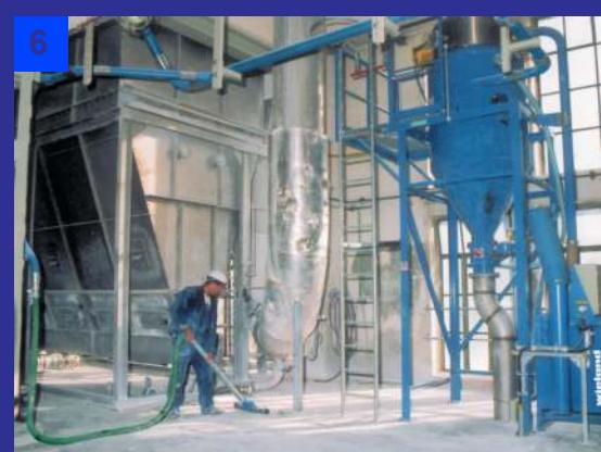
1. **VacTrailer S-4** (42 кВт). Вакуумная очистка сборного бункера газоочистного фильтра на угольной электростанции.
