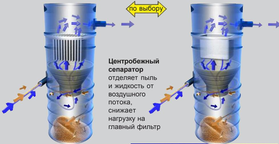
Центробежный сепаратор отделяет пыль и жидкость от воздушного потока, снижает нагрузку на главный фильтр
