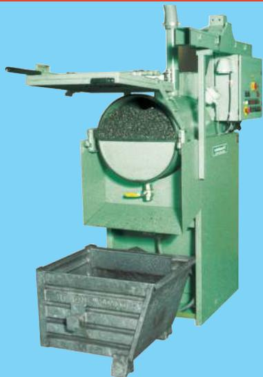
Стационарный агрегат FS, подключенный к системе вакуумного трубопровода, централизованно собирает стружку и СОЖ от производственных станков, сепарирует и очищает СОЖ от опилок и грязи и закачивает ее обратно в исходные емкости. Стружка выгружается в контейнер для последующей утилизации.
