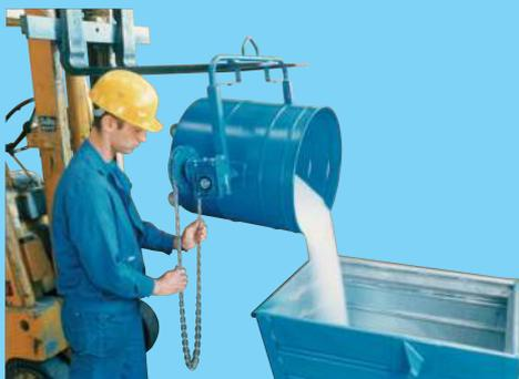
Надежная и безопасная система выгрузки уловленного материала с помощью опрокидывающего устройства с редуктором, удобно при выгрузке тяжелых материалов и жидкости.
