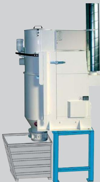
**Стационарное исполнение IS-56** для подключения к системе централизованного трубопровода. Монтируется на опорной раме для выгрузки в контейнер-сборник или на транспортировочный конвейер.
