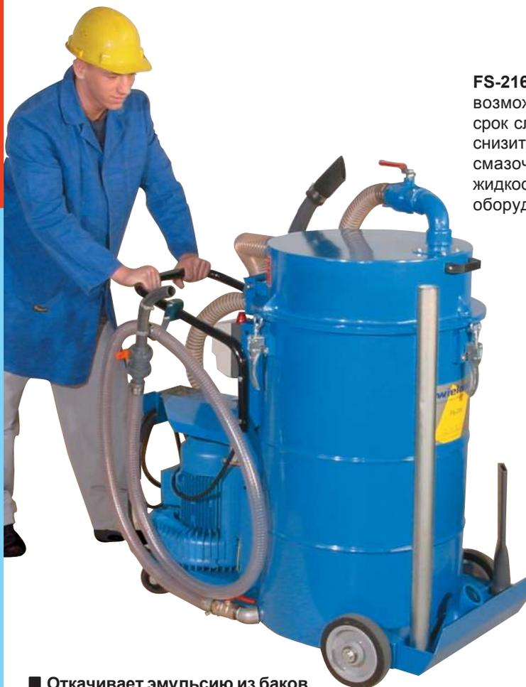
FS-216 - это возможность продлить срок службы станков и снизить затраты на смазочно-охлаждающие жидкости и очистку оборудования.
