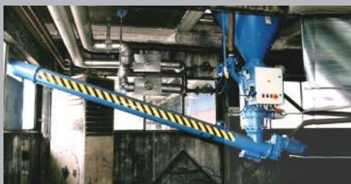
Стационарный вакуумный агрегат, предварительный сепаратор и система вакуумного трубопровода. Взрывозащищенные разгрузочные устройства: двойной сдвижной клапан, шнековый транспортер.
