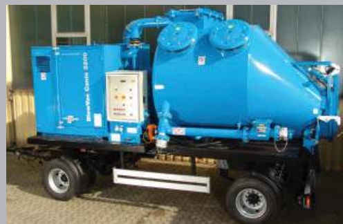
Передвижной автономный вакуумный погрузчик на базе грузового а/м или прицепа. Мобильное решение для уборки территории всего предприятия.
