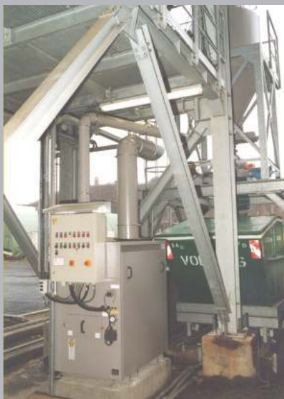
Компактный вакуумный агрегат KS-370 P - Мощность 37 кВт - Макс. сила всасывания 550 мбар - Расход воздуха (макс. производительность при всасывании) 2100 м³/ч
