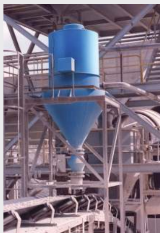
Фильтр-сепаратор с выгрузкой на ленточный конвейер
