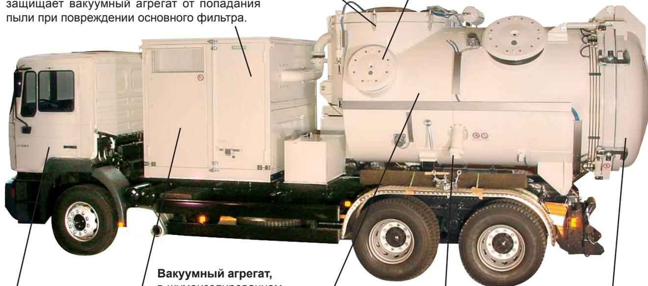
3-х осный рамный тягач, грузоподъемность 24 т
