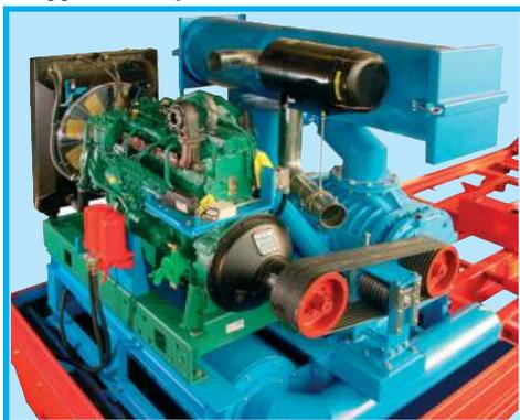
Не требующий обслуживания, стойкий к резким изменениям предельных нагрузок, роторный вакуумный насос с приводом от дизельного двигателя 81-240 кВт.
